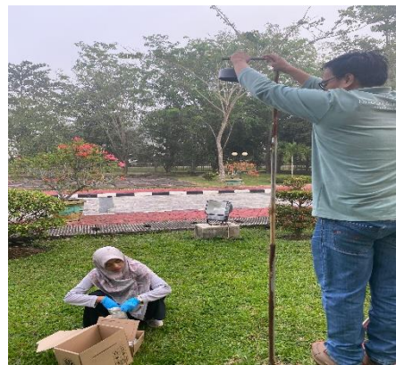
Gambar 3.4 Kegiatan Pemantauan Kualitas Udara dengan Metode Passive Sampler oleh Tim Dinas Lingkungan Hidup Kabupaten Siak
